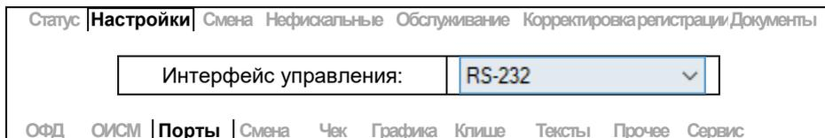
Или вручную установить параметр #2 в «0» (для интерфейса управления):
